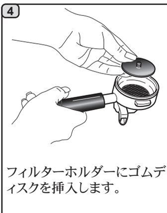
4 フィルターホルダーにゴムディスクを挿入します。
